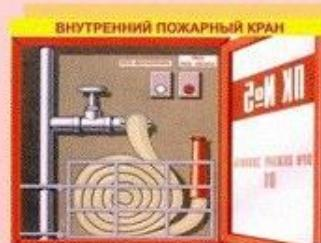
предназначен для тушения загораний различных объектов, **кроме электроустановок под напряжением**.
